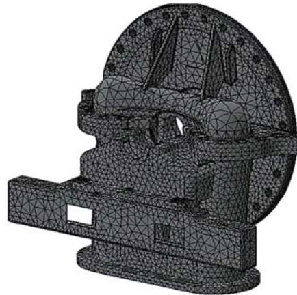
Рис. 4. КЕ сітка частини компресорної установки
